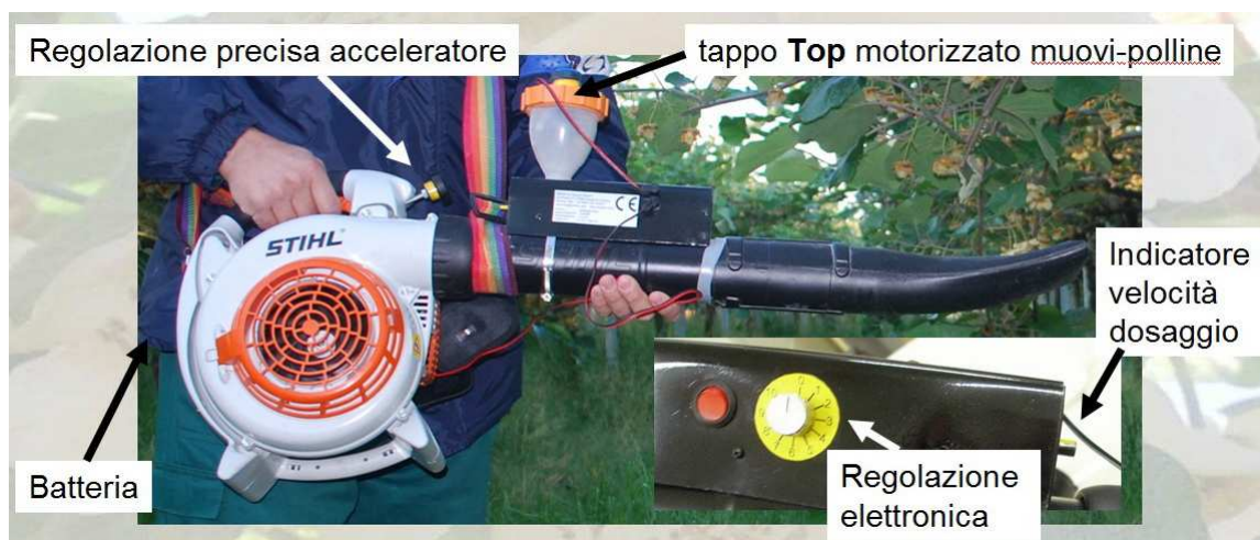
Figura 7 Attrezzatura utilizzata nelle prove di impollinazione a secco con polline puro e con indicazione delle relative parti e comandi (SoffiaPolline Biotac).
